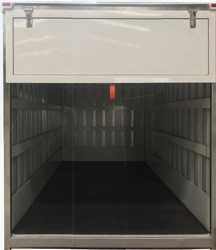
Partiendo de un vehículo transformado se monta una caja con un formato la cual es capaz de aprovechar al máximo el espacio de carga, sin pases de rueda en el interior.
