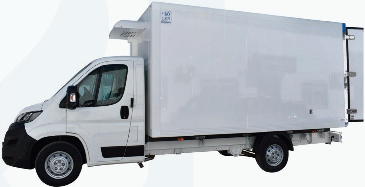
Partiendo de un vehículo transformado se monta una caja con un formato la cual es capaz de aprovechar al máximo el espacio de carga, sin pases de rueda en el interior.
